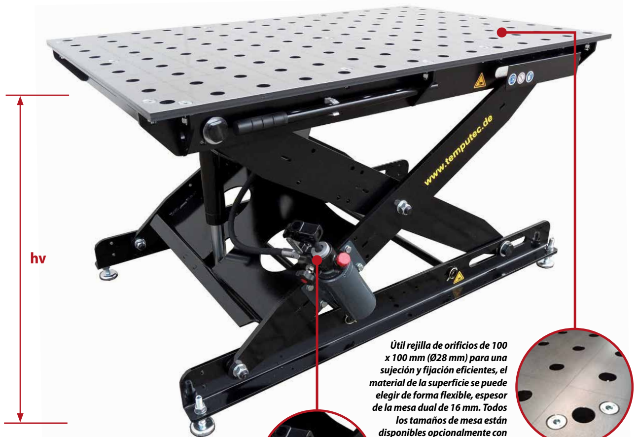
S Fig.: Temputec SST 65-105 / 16 S con ajuste hidráulico de altura de 650 a 1.050 mm, dimensiones de la placa de 1.400 x 900 mm, color negro estándar
